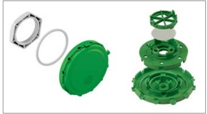
**Bild 4:** Der permanente Druckausgleich entlastet die Dichtung und verhindert, dass mechanische Kräfte auf das Gehäuse einwirken können – die Beibehaltung der hohen Schutzart IP65 ist hierbei sichergestellt
