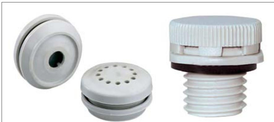
**Bild 2:** Belüftungstutzen gewährleisten den Luftaustausch, wodurch Feuchtigkeit aus dem Gehäuse transportiert wird – möglich bis IP44. Ein Druckausgleichselement mit luftdurchlässiger und wasserdichter Spezialmembranfolie vermeidet Kondenswasserbildung
