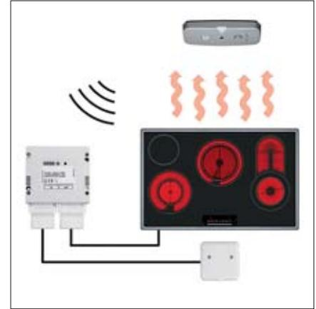
**Bild 3:** Die Sensoreinheit des Herdwächters überwacht das Kochfeld und sendet ein Funk-Signal an die Steuereinheit, die die Stromzufuhr zum Kochfeld automatisch unterbricht
