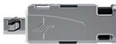
Bild 7: Ein feldkonfektionierbarer SPE-Stecker nach IEC 63171-2
