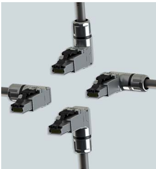
Bild 5: Beim feldkonfektionierbaren RJ45-Stecker »MFP8 4x90« kann der Kabelabgang vor Ort nach oben, unten, links oder rechts gewählt und auch nachträglich geändert werden
