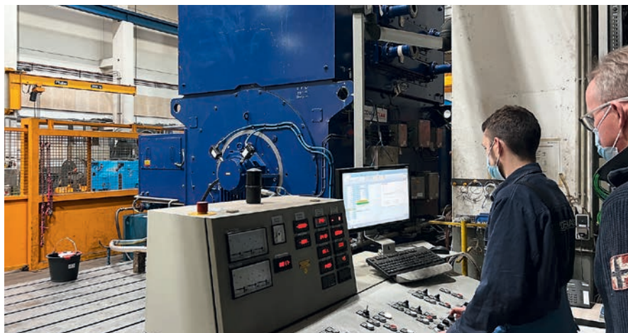
Bild 4: Abnahmeprüfung eines instandgesetzten Motors im Prüffeld
