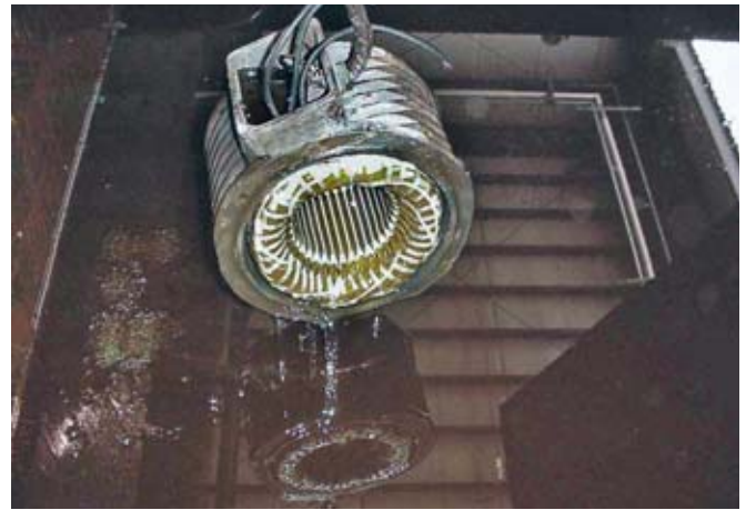
Bild 5: Vor der Tauchimprägnierung wurde dieser Stator in einem Ofen erhitzt
