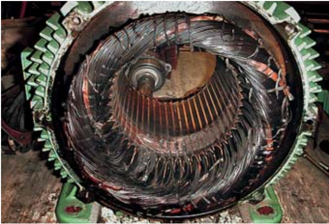
Bild 1: Dieser Stator mit Träufelwicklung (runder Magnetdraht) wurde durch Kontakt mit dem Rotor beschädigt
