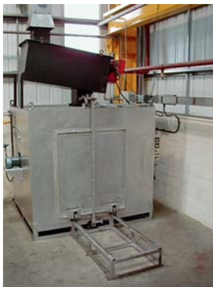
Bild 3: Der Pyrolyse-Ofen sollte über einen Teilmotorsensor und Wasserspray zur Temperaturregelung verfügen
