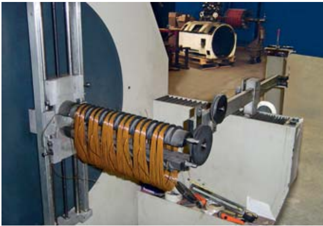
Bild 4: Anbringen von Träufelwicklungen der Klasse H auf einer halbautomatischen Wickelmaschine
