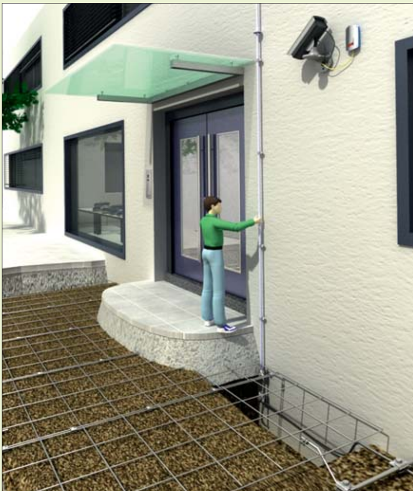
Bild 4: Einsatz einer CUI-Leitung im Eingangsbereich eines öffentlichen Gebäudes
