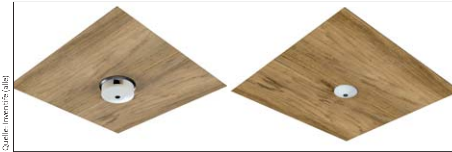
Bild 1: Den Raumsensor gibt es in einer AP- und in einer UP-Variante; für den Anschluss ist jeweils ein Netzkabel erforderlich, das sowohl die Kommunikation als auch die Energieversorgung per Power over Ethernet übernimmt
