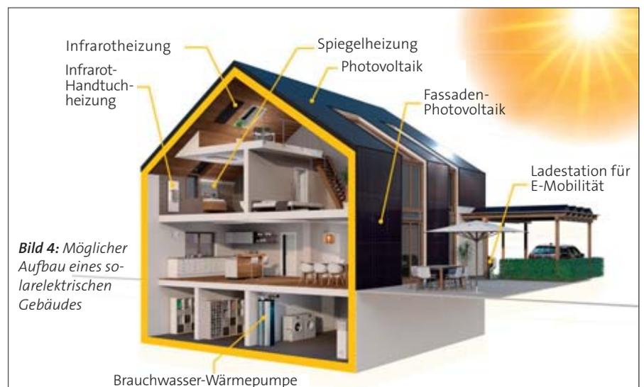
**Bild 4:** Möglicher Aufbau eines solarelektrischen Gebäudes
