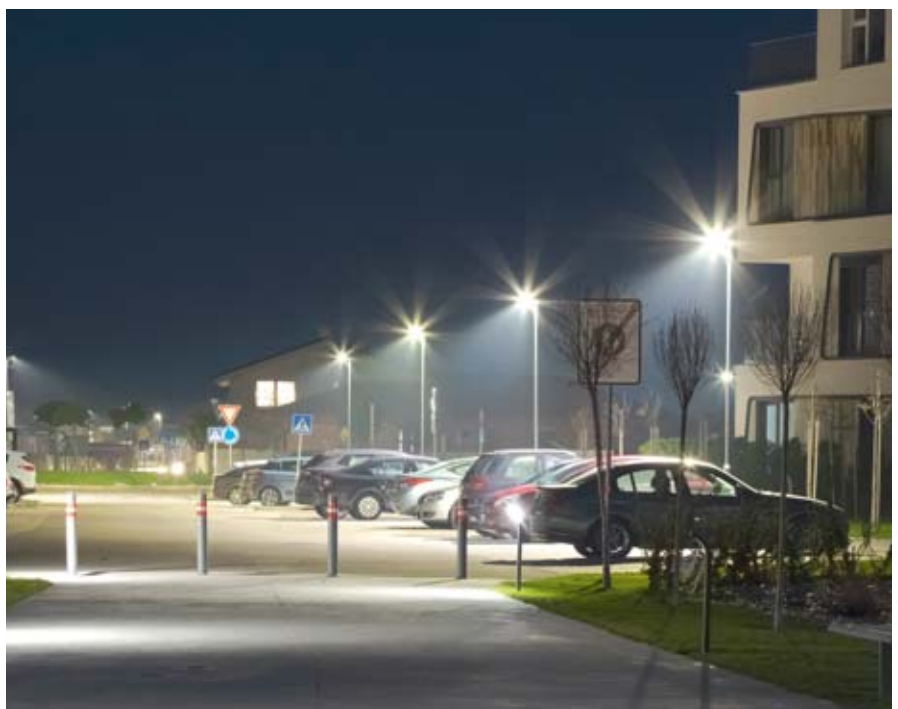
Bild 2: Die Außenleuchte VIA im Einsatz: Mit einem Upward Light Ratio ULR von 0 % erfüllt sie die DarkSky-Anforderungen
