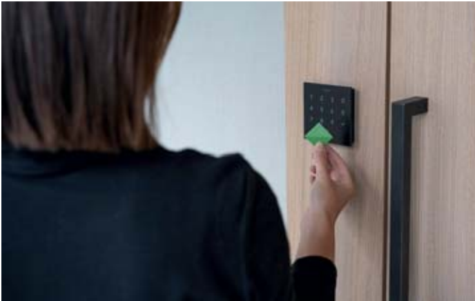
Bild 2: Auf dem Keyfob hinterlegte Berechtigungen werden über die Nahfeldkommunikation berührungslos an den Zutrittsleser übermittelt
