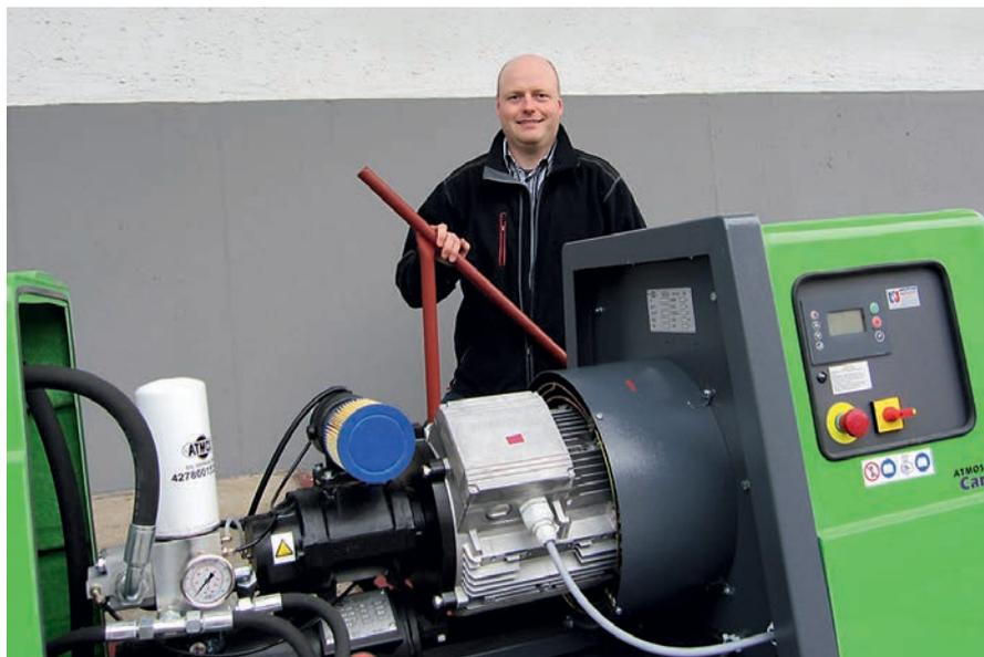
**Bild 4:** Klaus Wuttke präsentiert stolz einen Schraubenkompressor der Leistungsklasse 11 kW
