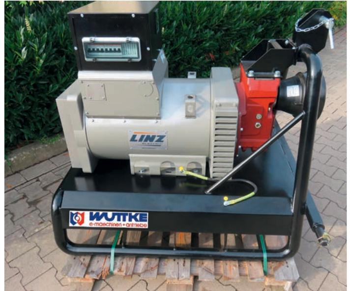
**Bild 3:** Ein von Klaus Wuttke modifizierter Zapfwellengenerator – dieser verfügt nun über sicheren Kurzschlusschutz, Schiefastfähigkeit bis 30 % sowie die Überwachung aller drei Außenleiter per Spannungsregler
