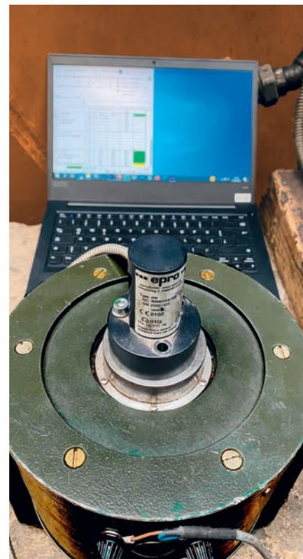
**Bild 3:** Prüfung eines Lagerschwingungssensors auf dem Schwingtisch
