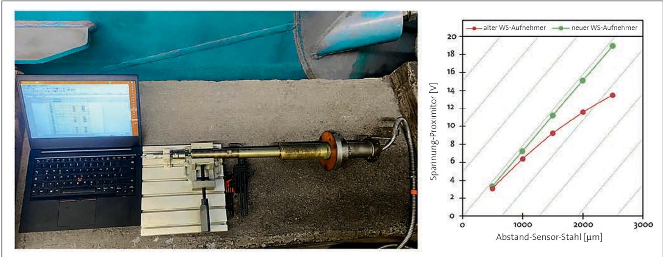
Bild 4: Kennlinienprüfung eines Wellenschwingungssensors (li.); rechts ein Diagramm mit Kennlinienvergleich
