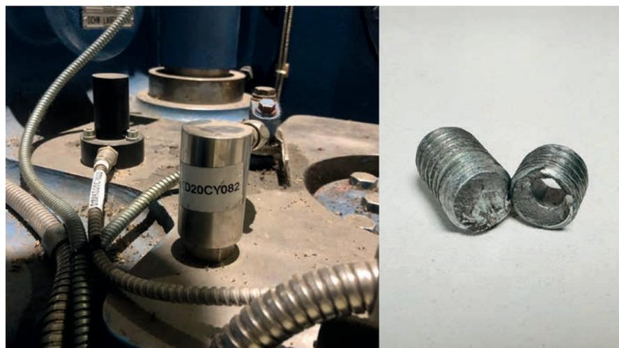
**Bild 6:** Zwei seismische Lagerschwingungssensoren (li.), gebrochener Befestigungsbolzen (re.)
