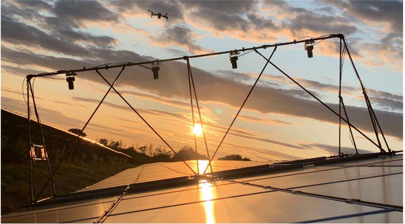
**Bild 5:** Prüfung im laufenden Betrieb: EL-Messungen mit auf Rahmen montierten Kameras; so wird ein gleichmäßiger Abstand zu den Modulen gewährleistet. Die Messungen können auch per Drohne erfolgen
