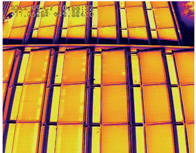
**Bild 4:** Zu sehen sind einzelne hellere Zellen, die auf Defekte hinweisen. In diesem Beispiel wird als Ursache mechanische Belastung vermutet
