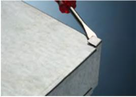
**9a.** Bei schon verlegten Kabeln können die Boxen durch Hochbiegen der Ecklaschen geöffnet und um die Kabel gelegt werden.
