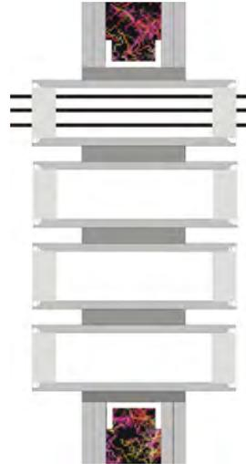
**13.** Gruppen von Boxen in leichten Trennwänden müssen oberhalb und unterhalb durch einen Riegel umfasst werden.
