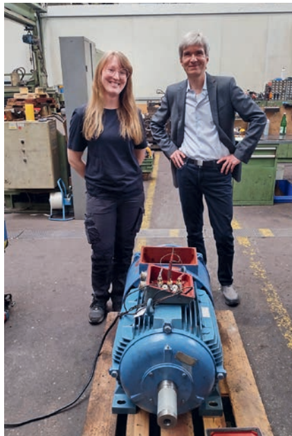
Bild 1: »Duett komplett« vor einem Schleifringläufermotor mit 48 kW und Baugröße 250
