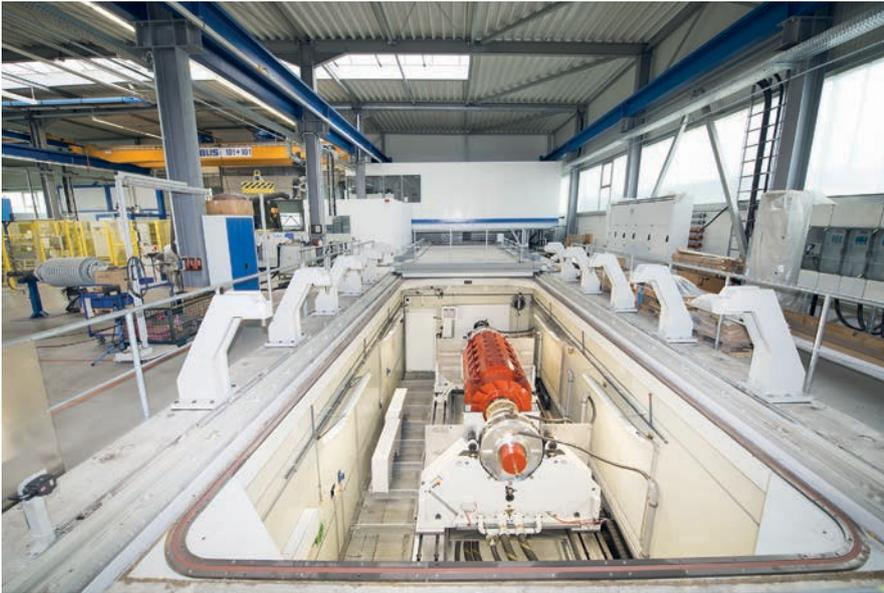
Bild 2: Die 2011 in Betrieb genommene Wucht- und Schleudernanlage bei Partzsch
