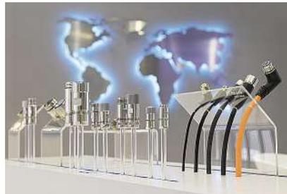
Der Winkelsteckverbinder aus der Serie »M23« lässt sich stufenlos bis zu 300° drehen. Diese Steckerfamilie gibt es für die Anwendungsbereiche Signal, Leistung und Industrial Ethernet. Verschiedene Gehäusebauformen lassen sich mit zahlreichen Kontakteinsätzen kombinieren. Die Steckverbinder gibt es mit Schraubverschluss und auch mit dem Schnellverschluss »Twilock«, außerdem in Varianten, die steckkompatibel zum Verschlusssystem »Speedtec« sind.
