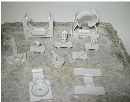
Es gibt unterschiedliches Zubehör: Mit Dreh- oder Steckverriegelungen lassen sich die Rohre auf alle gängigen Kabeltrassen mit Lang- oder Rundlöchern befestigen und mit einem Gewinde-Clip an Gewindestangen. Mithilfe einer Klebeplatte wird die Leitungsbefestigung auf den Untergrund geklebt. Ein neuer Schuss-Clip erlaubt die Schusstechnik speziell auf Betondecken und -wänden.
