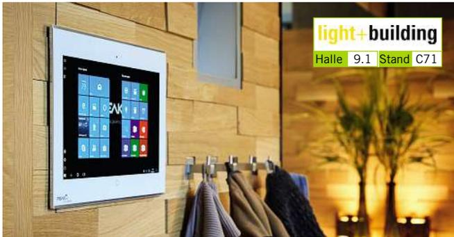
Mit »Controlmini« zeigt Peaknx ein neues Touchpanel zum Einsatz in Smart Homes. Es handelt sich um einen vollwertigen Rechner aus Industriekomponenten. Er arbeitet unter Windows 10 Professional und verfügt über direkte Anschlüsse an KNX, USB und Ethernet. Neben der Raum- oder Haussteuerung kann das Panel auch als Gegensprechanlage an Türen dienen.
