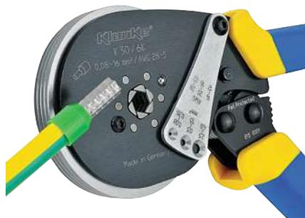
**Bild 3:** K 306K heißt das mechanische Presswerkzeug von Klauke für Aderendhülsen von 0,08mm<sup>2</sup> bis 16mm<sup>2</sup>
