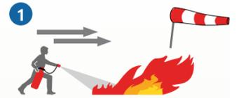
Wer zum Feuerlöscher greift, muss immer auf die Windrichtung achten und genügend Abstand zum Feuer halten. Die Flammen nicht direkt löschen, sondern das Brandgut. Dabei Stoßweise löschen und wenn möglich mehrere Löscher gleichzeitig einsetzen.
