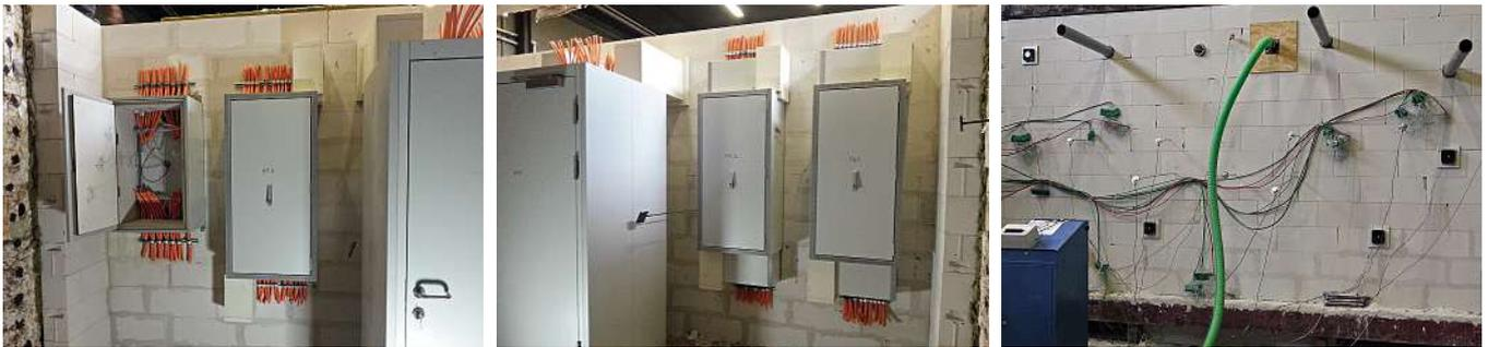
**Bild 6:** Testanordnung von aktiv belüfteten FE-Verteilern in einer MPA
