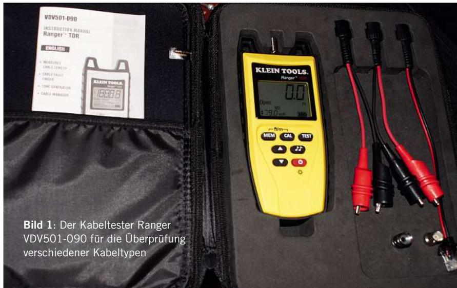
**Bild 1:** Der Kabeltester Ranger VDV501-090 für die Überprüfung verschiedener Kabeltypen
