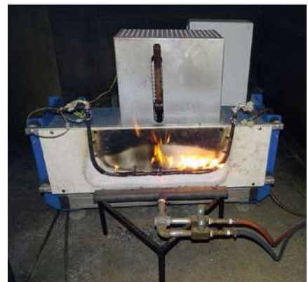
Bild 4: Brandprüfung des Kabels MegaLine F6-90 S/F CI mit Funktionserhalt gemäß EN 50289-4-16
