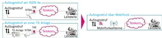
**Bild 4:** Anschlussmöglichkeiten für den Aufzugsnotruf, links: bisher, rechts: neu
