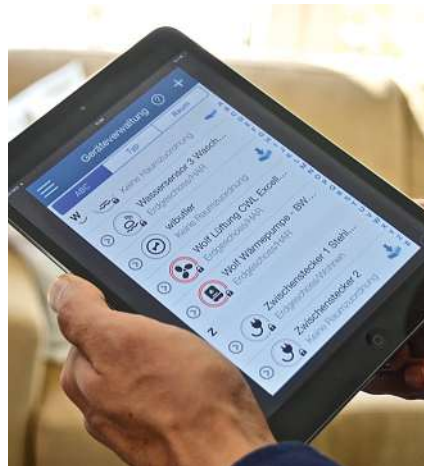
Bild 6: Das gesamte Haus und seine gebäudetechnischen Funktionen sind über die wibutler-App steuer- und konfigurierbar
