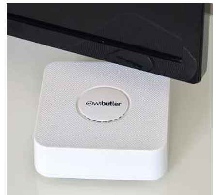
Bild 3: Der wibutler pro ist das Herzstück der ganzen Anlage und kann Internet-unabhängig durch ein eigenes Funknetz bereits in der Rohbauphase des Hauses konfiguriert werden
