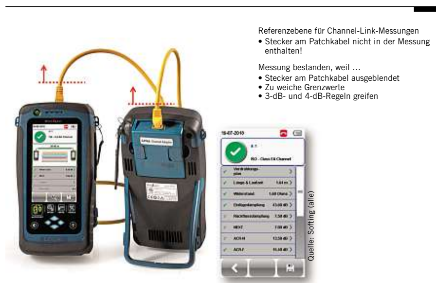
Bild 1: Messung eines Patchkabels der Kategorie 5 (bis 100 MHz) gegen Channel-Link-Grenzwerte Klasse EA (bis 500 MHz)
