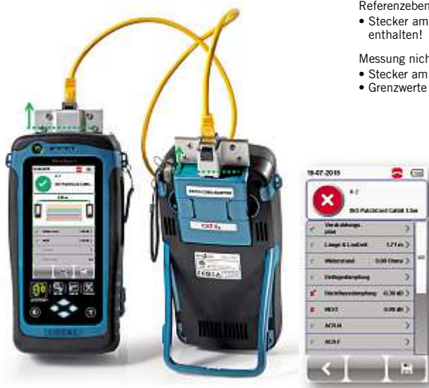
Bild 2: Messung eines Patchkabels der Kategorie 5 (bis 100 MHz) gegen Patchkabel-Grenzwerte Kategorie 6A (bis 500 MHz)
