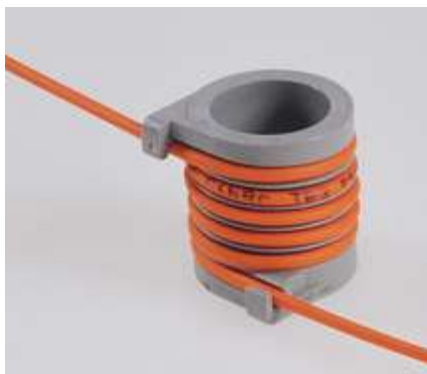
Bild 4: Ein Mandrel Wrap beseitigt die Moden höherer Ordnung bei Multimode-Dämpfungsmessungen unter Verwendung einer LED-Lichtquelle
