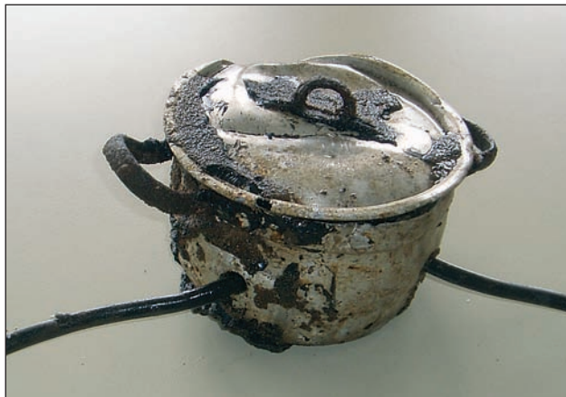
Bild 130: In der Erde vergrabener, mit Teer gefüllter Kochtopf, der als Kabelmuffe diente
