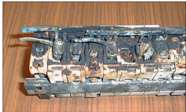
Bild 3: Durch Hitze geschmolzene Kupferschiene sowie typische Perlenbildung durch Hitze
