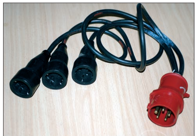
Bild 132: Fachwissen gehört zweifelsohne dazu, sich auf solche Art und Weise von einer Drehstromsteckdose die benötigte Wechselspannung zu generieren; trotzdem dürfte diese Bastelarbeit nicht mit den Normen in Einklang zu bringen sein
