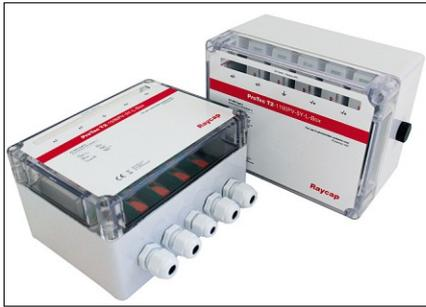
**Bild 10:** Die PV-Boxen ProTec T2 schützen als externe Überspannungs-Schutzeinrichtungen PV-Wechselrichter, die auf DC-Seite nicht gegen Überspannungen abgesichert sind
