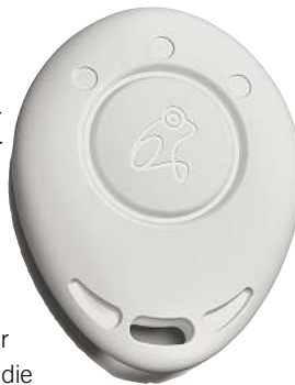
Bild 3: Der Transponder ermöglicht die Bedienung per Klick und/oder per Gestensteuerung
