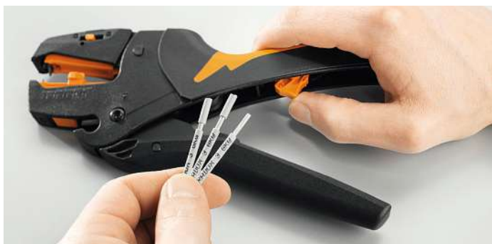
Bild 2: Bei der Teilabisolierfunktion verbleibt der Isolationsrest auf dem Leiter und verhindert so dessen Aufspießen
