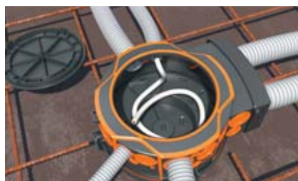
Bild 9: Einbaugehäuse für Beton mit Platz für bis zu 25 Rohre; ausgestattet mit Membrantechnik, Zugentlastung und Verhinderung von zu weitem Einschieben der Rohre
