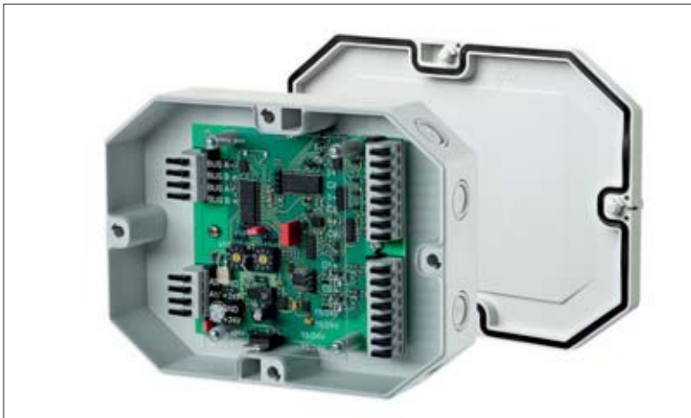
Bild 4: Das Innenleben des dezentralen Moduls »MR-AIO4/2-IP65 Modbus RTU« mit vier einzeln konfigurierbaren Eingängen und zwei analogen Ausgängen
