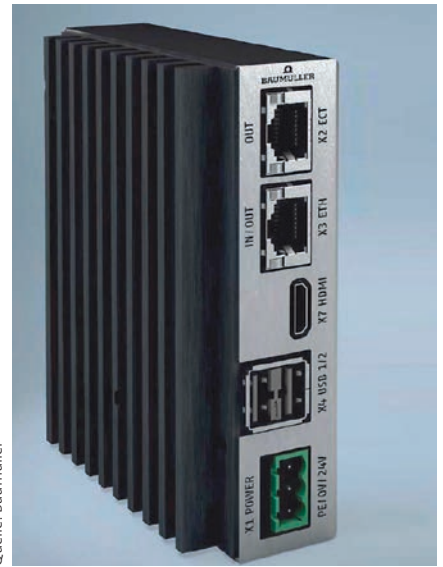
Bild 2: Der Nürnberger Anbieter Baumüller zeigte u. a. seine Steuerungsplattform »b maXX PLC«, die Industrie-PC und PLC-Steuerung kombiniert
