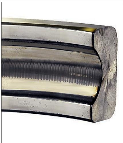
**Bild 1:** Lager mit Riffelbildung – ein durch Elektroerosion verursachter »Washbretteffekt« an der Lauffläche
