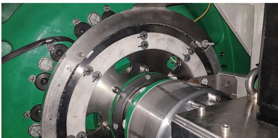
**Bild 4:** Nach Montage des PRO-Rings konnte die Wellenspannung auf weniger als einem Volt gesenkt werden
