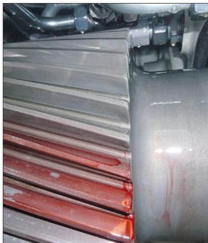
**Bild 2:** Getriebe mit Streifenbildung durch Stromübergang, den sogenannten »tiger stripes«
