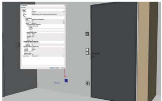
**Bild 7:** Die in DDS-CAD hinterlegten Bauteilinformationen können von AVA-Softwaresystemen zum Anlegen der Leistungsverzeichnisse genutzt werden
