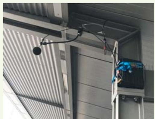
**Bild 10:** Messstation unter einem Bahnsteigdach zur Langzeiterfassung des Störpegels
