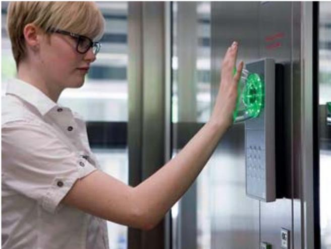
**Bild 2:** Für eine Zwei-Faktor-Authentifizierung im Aufzug lässt sich die Handvenenerkennung mit PIN oder RFID-Ausweis kombinieren
