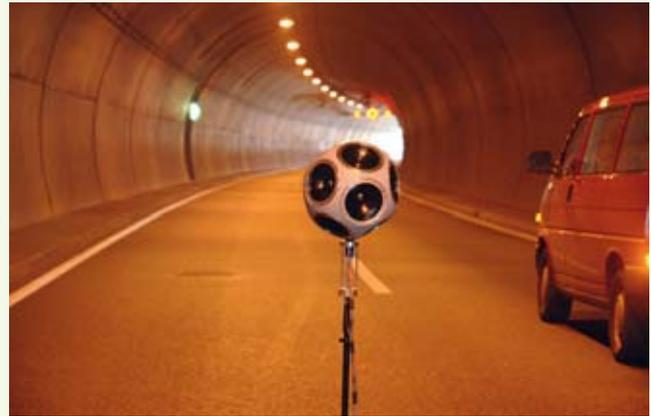
**Bild 8:** Nachhallzeitmessung mit einem Dodekaeder-Lautsprecher in einem Tunnel
