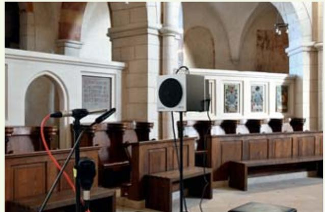
**Bild 17:** Die »NTI Talkbox« als normgerechter Sprechersatz für Messungen der Sprachverständlichkeit über eine Sprechstelle. Hier im Einsatz für das Mikrofon am Priestersitz des Limburger Doms
