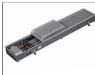
Mit dem »Katherm HK E« bietet **Kampmann** einen Unterflurkonvektor in Zwei-Leiter-Ausführung an, der zusätzlich zu den Funktionen Heizen und Kühlen auf Wasserbasis elektrisches Heizen ermöglicht. Über einen integrierten, stufenlos regelbaren Elektroheizstab können beispielsweise in einem Bürogebäude Raumnutzer ihr Büro heizen, obwohl sich die Gesamtanlage noch im Kühlbetrieb befin-
