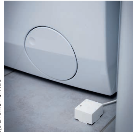
Bild 3: Die Wassermelder »WM5« sind mit zwei Elektroden ausgestattet, die ansteigendes Wasser detektieren und eine Alarmierung über die Gefahrenmelderzentrale übermitteln
