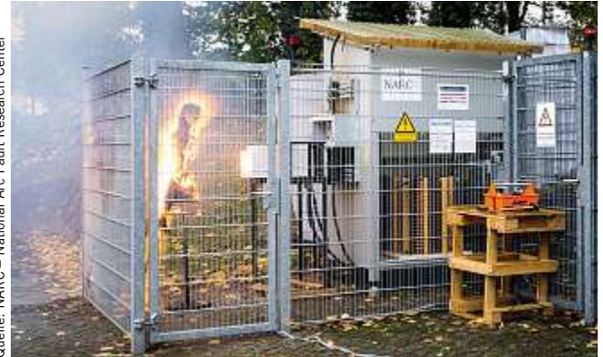
Bild 7: Die Kleidung des Dummy gerät durch den Lichtbogen in Flammen
