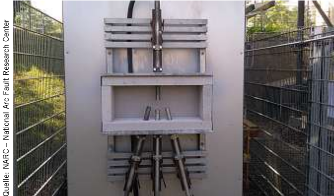
Bild 5: Versuchsaufbau für einen dreipoligen Störlichtbogen am Versuchsstand des NARC
