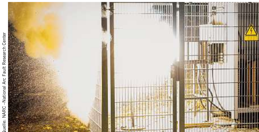
Bild 6: Störlichtbogen beim dritten Experiment mit Lichtbogen-Dummy
