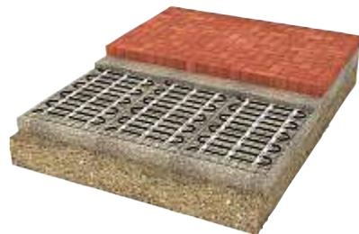
**Bild 4:** Aufbau eines beheizten Gehweges mit Stein- oder Plattenbelag
