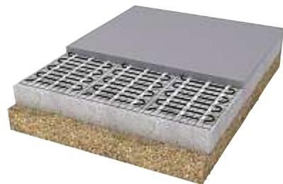
**Bild 5:** Aufbau einer beheizten Fläche mit Estrichbelag
