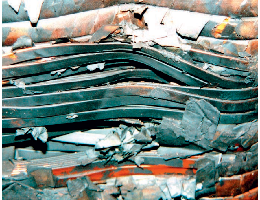
Bild 5: Dieser ausgeprägte Schaden an einer Unterspannungsspule (Wicklungsschluss in der dritten Lage) war erst nach dem Abwickeln der oberen Wicklungslagen feststellbar
