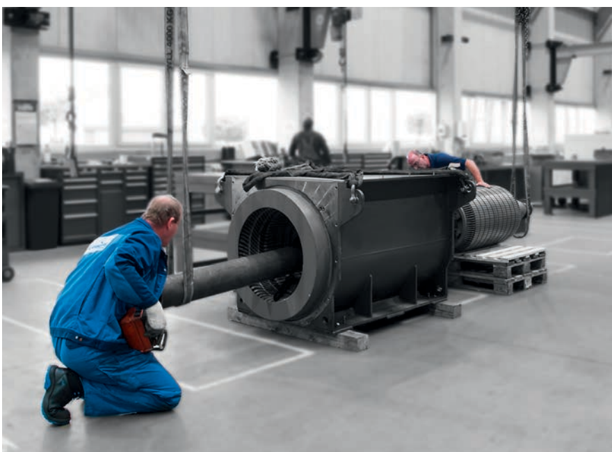
Bild 4: Ein Blick in die Abteilung Service und Instandhaltung – in der komfortablen, hellen und technisch gut ausgestatteten Halle sind die beiden Mitarbeiter mit der Demontage eines Antriebs beschäftigt
