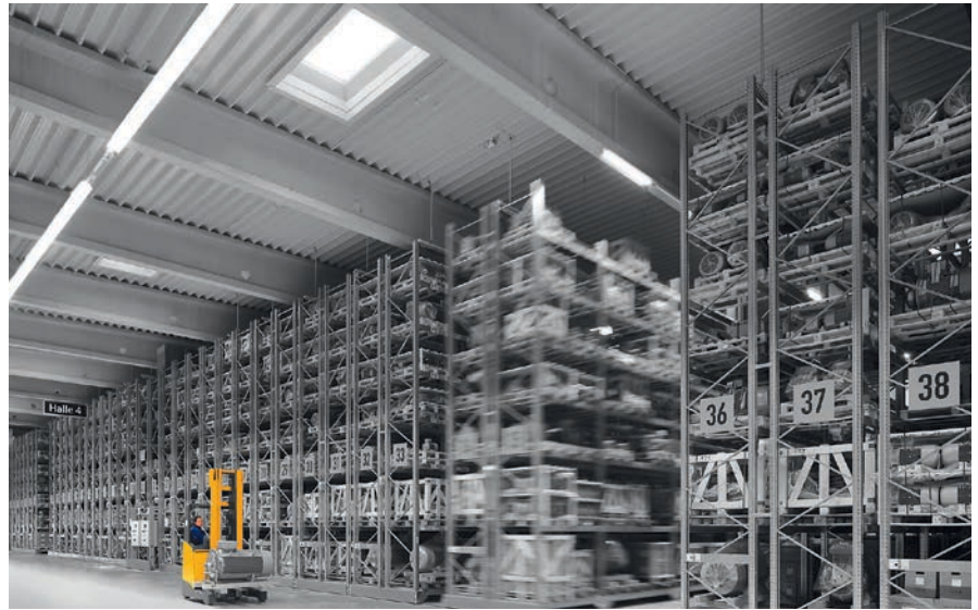
Bild 5: Um ständig 60 000 Antriebe vorrätig zu haben, benötigt man ein kluges Konzept – die Paletten werden mit EDV-Unterstützung ein- und ausgelagert
