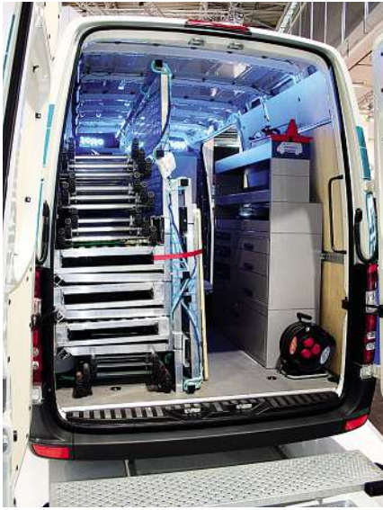
Bild 7: Der Frachtraum des 3,5-Tonnners lässt sich aufs Nutzerprofil ausrichten – einerseits der sichere Materialtransport, andererseits die kleine Werkstatteinrichtung
