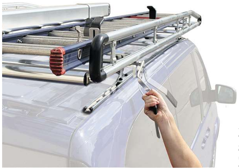
Bild 6: Mit der Schnellverriegelung »S-Clamp« kann der Handwerker die Leiter auf einem Dachträger binnen Sekunden arretieren. Per Vorhangschloss lässt sich die Steighilfe sichern
