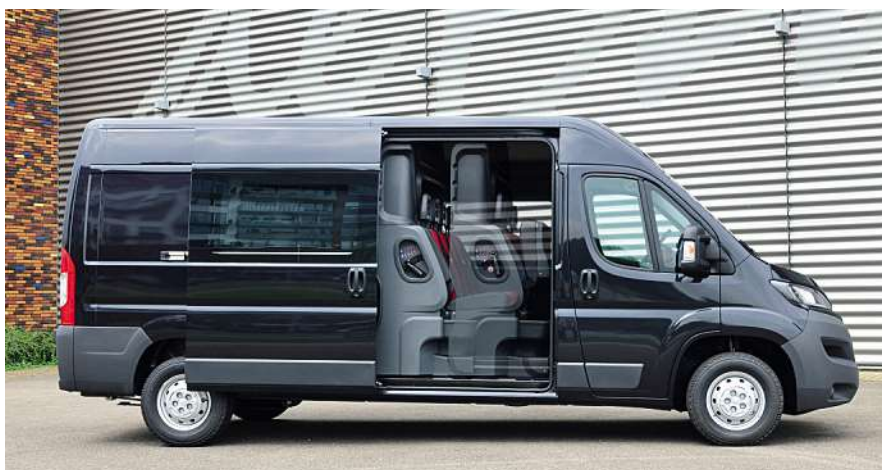
Bild 1: Verschiebbare Trennwand mit Sitzen – FlexCab nennt Ausbauer Snoeks diese neue Variante für die besonders variable Nutzung des Frachtraums (hier beim Peugeot Boxer)
