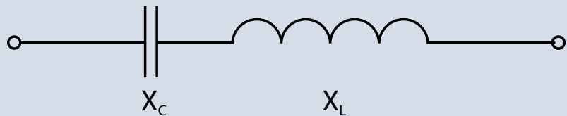
Bild 13: Ersatzschaltbild einer verdrosselten Kompensationsstufe
