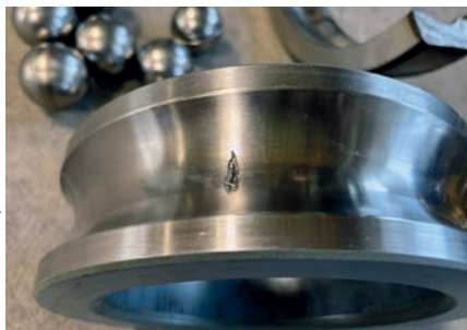
Bild 6: Ausbruchsstelle im inneren Lagerring
