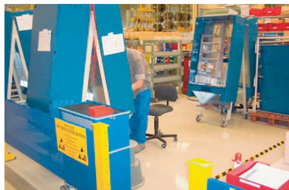
Bild 2: Kennzeichnung ESD-geschützter Bereiche
