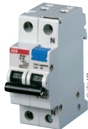
Bild 1: RCD vom Typ A; Auslösung bei Wechsel-Fehlerströmen und pulsierenden Gleich-Fehlerströmen (pulsstromsensitiv), mit einem Bemessungsstrom von 16 A und I_{\Delta N} \leq 30 \text{ mA} ; kombiniert mit einem Leitungsschutzschalter B16 A
